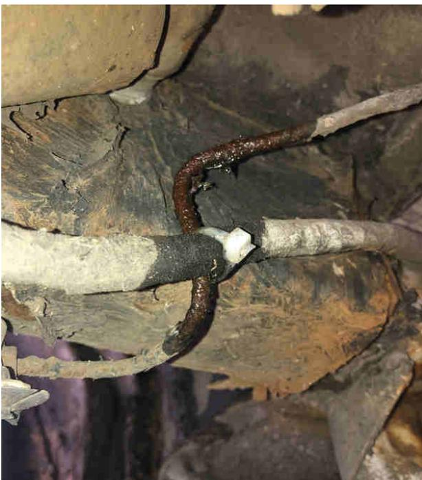
Unter anderem war die Bremsleitung des Sprinters korrodiert und undicht.
